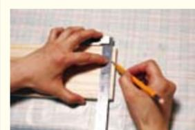
ひとさし指でスコヤが浮かないように押さえ、残りの指で部材とスコヤをしっかりとはさんで固定してから、垂線を引きます。
